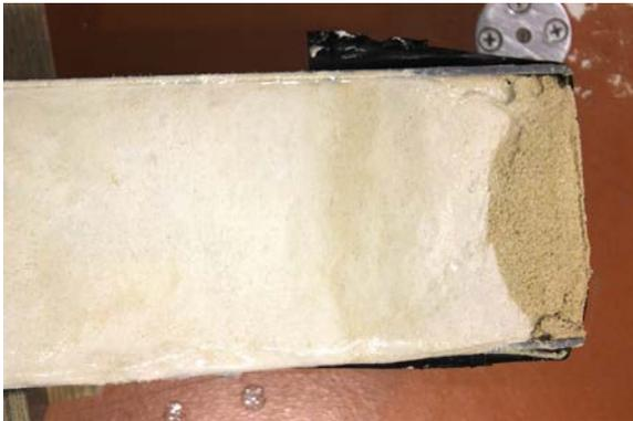
*Abb. 1 Sedimentkern von der Westflanke des MAR. Deutlich erkennbar ist die dunkelbraune Foraminiferensandlage an der Oberfläche, in der die feinen Sedimentanteile durch die Bodenströmung herausgewaschen ist.*
