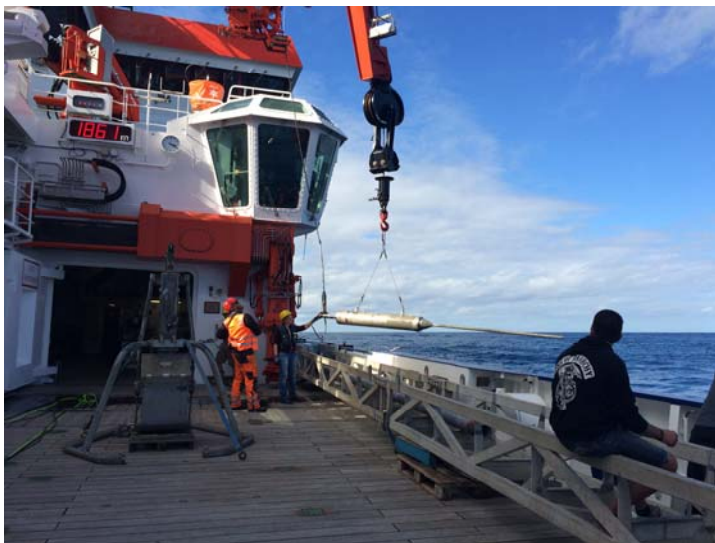
Abb. 3: Aussetzen der CPT-Lanze
