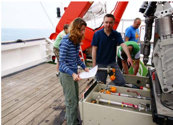
Abbildung 2: Vor dem ROV Quest Tauchgang werden neben dem Fahrzeug auch alle wissenschaftlichen Geräte im Fahrzeug platziert. Miriam Römer und Stephan Klapp haben gerade Gasblasenprobenbehälter vorbereitet und fertigen nun eine Skizze der Position der Geräte an, damit die Piloten beim Tauchgang auch die richtigen Instrumente greifen (links). ROV Quest wird am A-Rahmen des Schiffes vorsichtig zum nächsten Tauchgang ins Wasser gelassen (rechts).
