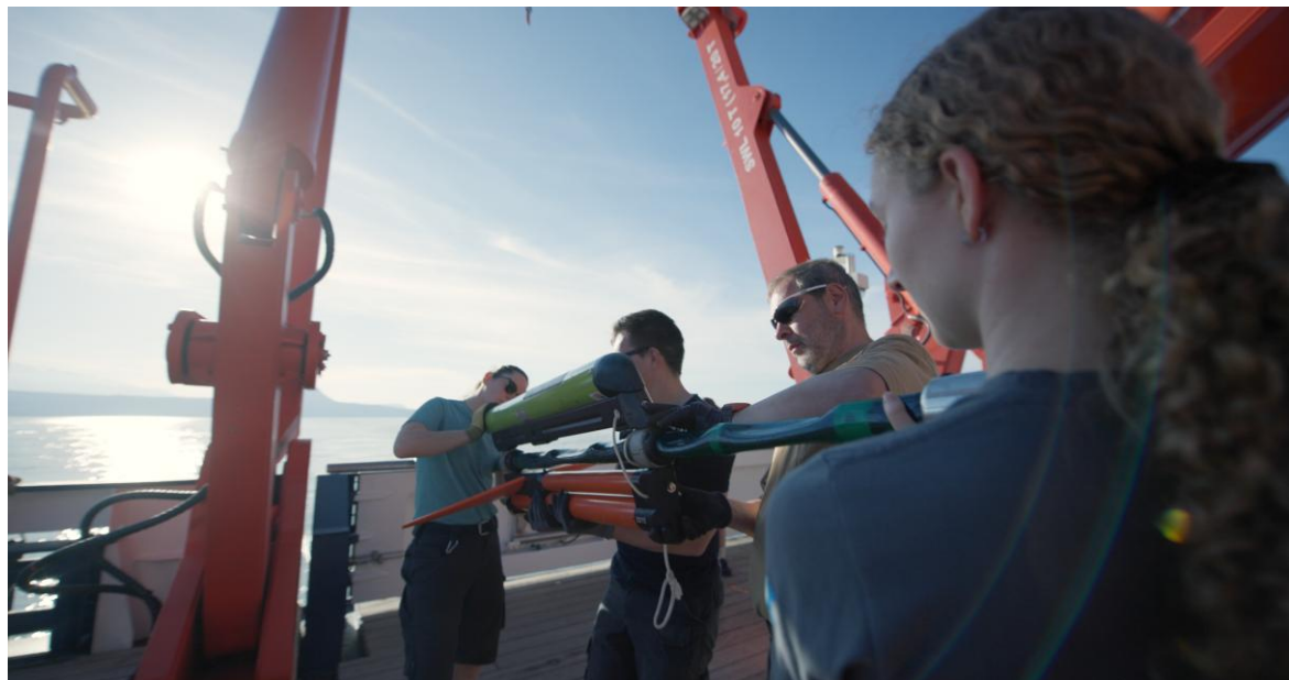
Abbildung 2: Ausbringen des 800 m langen Empfangssystems für die reflexionsseismischen Messungen. Foto: J. Vollert.
