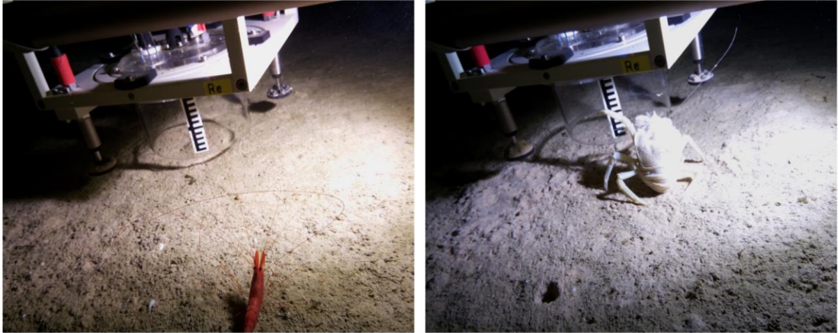
Abb. 2: Zylindrische Messkammern and der Vorderseite des Rovers werden bei der Messung in das Sediment eingefahren und dienen der Erfassung des Sauerstoffverbrauchs der in der Messkammer eingeschlossenen Lebensgemeinschaft. Krebse entziehen sich dieser Messung und verfolgen kritisch das Geschehen.
